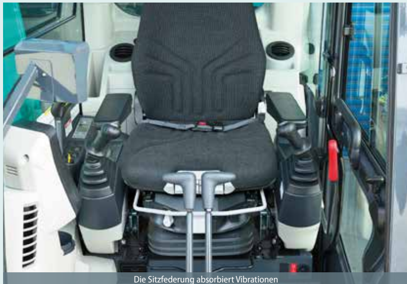
Die Sitzfederung absorbiert Vibrationen
