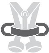
La ceinture de maintien au travail peut être utilisée seule (retenue) ou intégrée à un harnais antichute, (maintien au poste de travail). La longe de maintien au travail permet de relier une ceinture à un point d'ancrage (retenue), ou à une structure en l'entourant, de manière à pouvoir lâcher les mains (maintien au travail).
