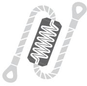
L'absorbeur d'énergie est obligatoirement utilisé dans des situations où l'utilisateur est exposé à un risque de chute. Le longe antichute sert à dissiper l'énergie en cas de chute et à limiter la force de freinage à un niveau non lésionnel.
