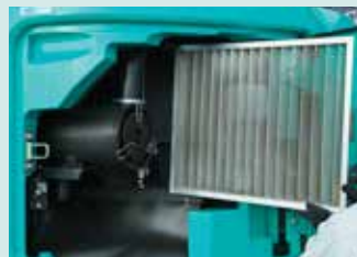
iNDR-Filter / Kühlmittelbehälter / Luftfilter
