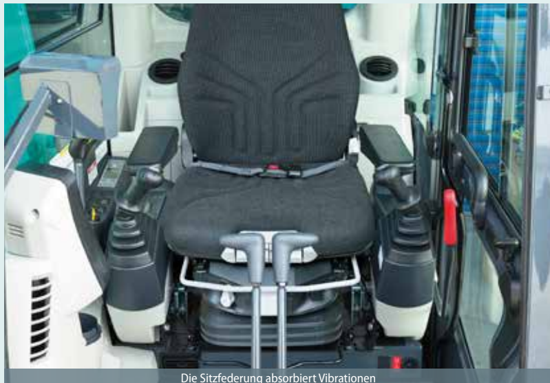
Die Sitzfederung absorbiert Vibrationen
