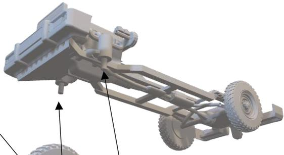
Wenn die Räder aufgesteckt sind kann das überstehende Kunststoffrundmaterial mit einem Lötkolben oder ähnlichem vorsichtig angeschmolzen werden um somit ein wieder abrutschen der Räder zu verhindern. Bitte nicht übertreiben um die Lenkbarkeit zu erhalten.
