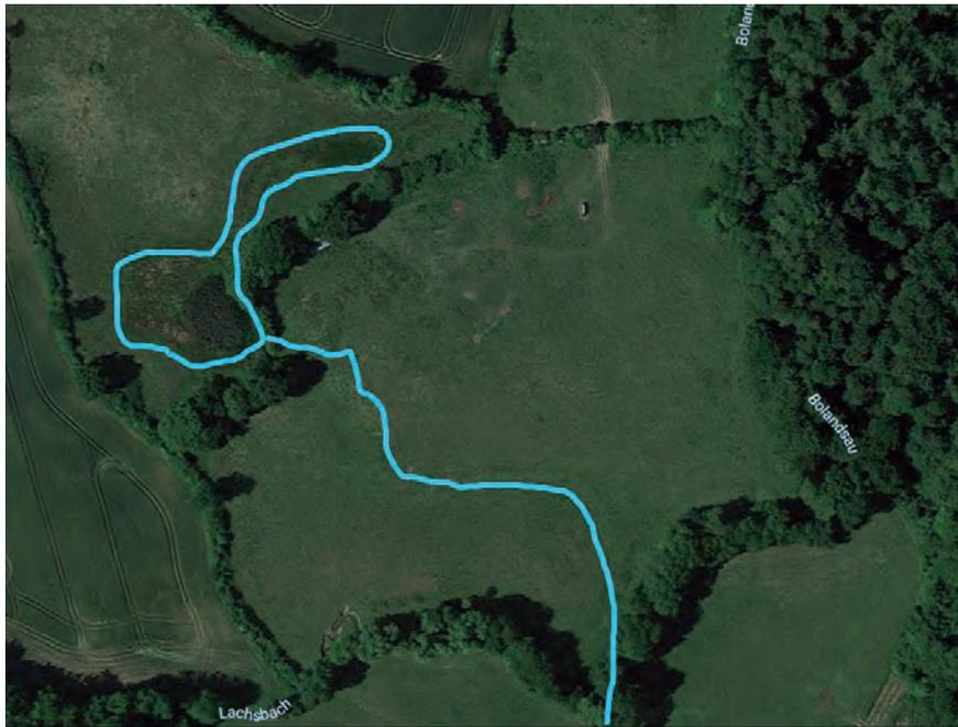
Abb. 1: durch Aufhebung der Drainage zu entwickelndes temporäres Kleingewässer und Überlauf in natürlicher Fließrinne, welche in den Lachsbach einmündet
