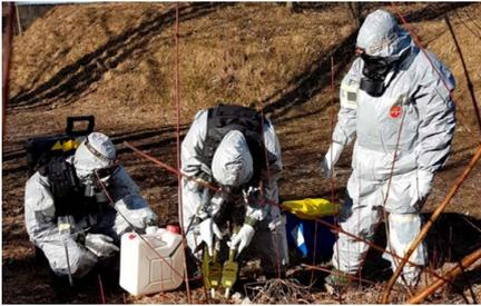
Die Fähigkeiten der Probennahme ermöglichen CBRN-Aufklärungs-, Überwachungs-, Mess- und Nachweisleistungen sowie Probennahme in kontaminierter und/oder nicht atembare Zone. Zusätzlich können die Spezialisten Kontaminationsgrenzen markieren sowie Aussagen über Art und Ausbreitung der Kontamination treffen. Für die unbemannte Aufklärung (Remote Control) können Hilfssysteme wie Drohnen oder Roboter eingesetzt werden.
