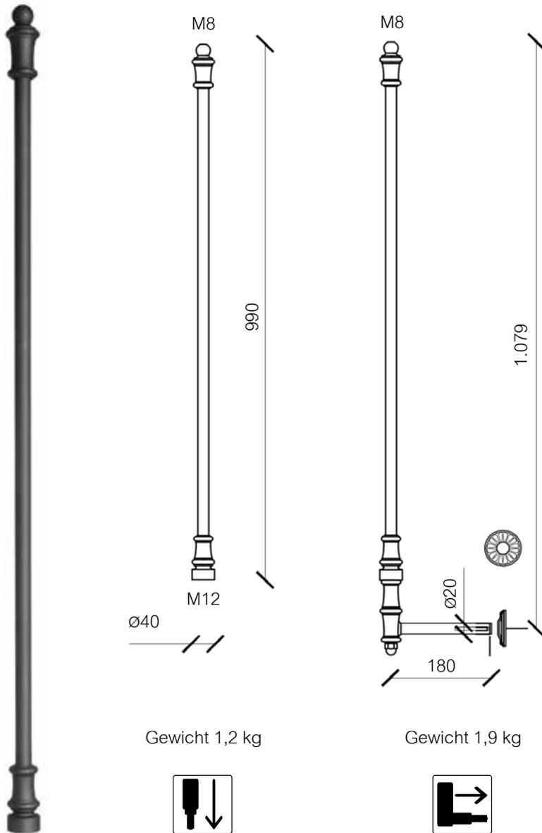
Dieser Geländerstab wird aus Aluminiumguss hergestellt.
