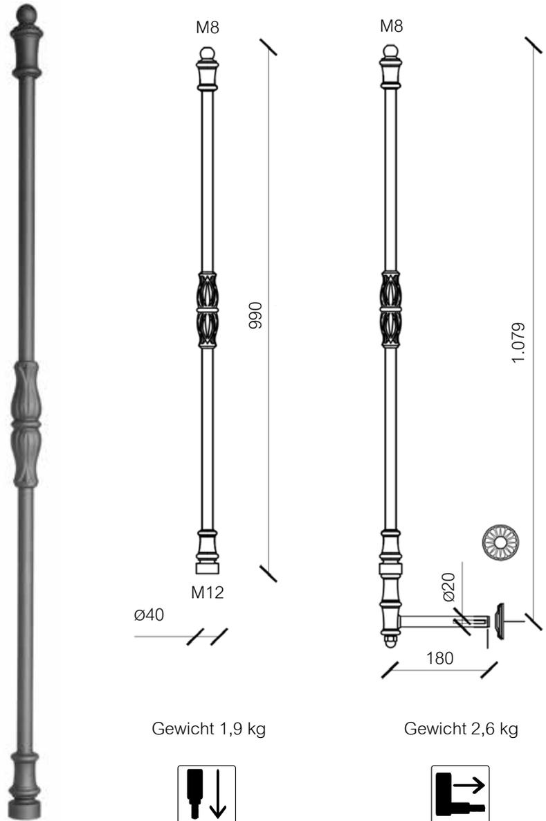
Dieser Geländerstab wird aus Aluminiumguss hergestellt.
